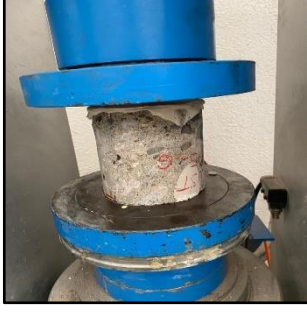
Şekil 5. Karot basınç dayanımı deneyi (A.Ferdi Şenol).
