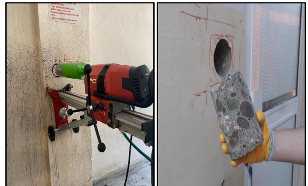
Şekil 4. Kolondan karot alınması (A.Ferdi Şenol).
