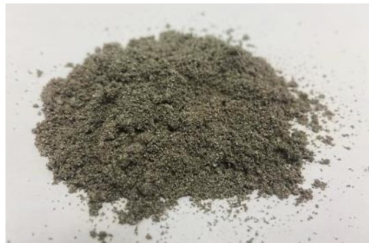
Şekil 1. Yeni Üretilmiş (Yaşlanmamış) MTV Piroteknigi
