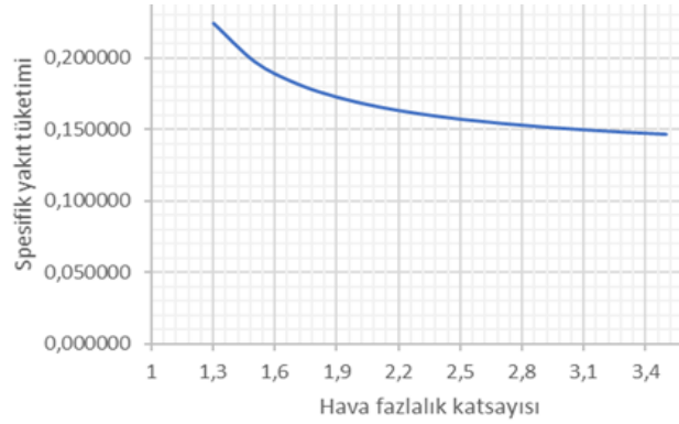
Şekil 11. Reküperatörlü gaz türbinli kombine güç çevriminde spesifik yakıt tüketiminin hava fazlalık katsayısı-hfk ile değişimi.
