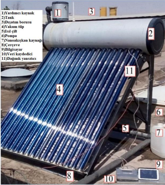
Şekil 5. Vakum tüplü güneş kolektör su ısıtma sisteminin tüm bileşenleri [16].
