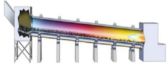
Şekil 2.1. Döner fırın ters akım prensibi kesiti
