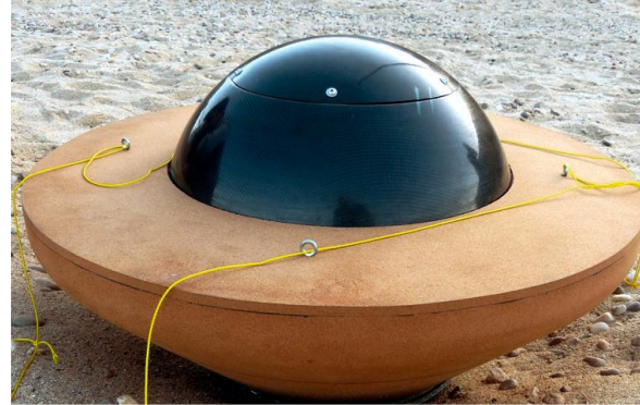
Şekil 3. Mars iniş kapsülü dış yüzeyinde mantar kaplama [13]
