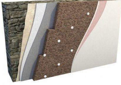
Şekil 1. Isı/ses yalıtımı için kullanılan sandviç yapılı bir mantar kompozit malzeme [6]
