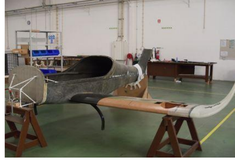
Şekil 2. Uçağın kanatlarında kullanılan mantar kompozit malzeme [7]
