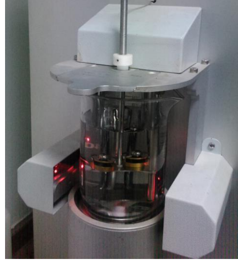
Şekil 2. Bitüm Yumuşama Noktası Deneyi Uygulaması
