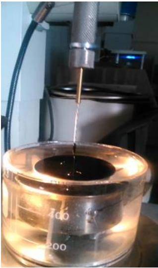
Şekil 1. Bitüm Penetrasyon Deneyi Uygulaması
