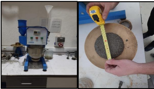
Şekil 3. Harç üretimi ve işlenebilirlik deneyi.
