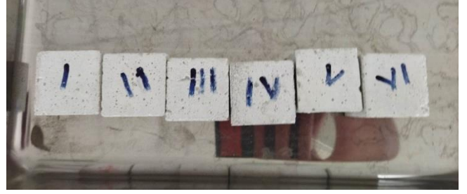
Şekil 2. Su emme deneyi öncesi KYH setleri genel görünümü
