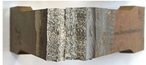
Şekil 3 S3 numunesinin çekme testi sonrası kırık yüzey makro görüntüsü
