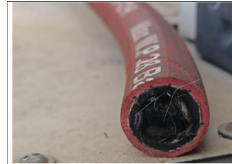
Şekil 4. Kalıp walgate soğutma kanalı tıkanıklığı mevcut durum
