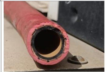
Şekil 5. Kalıp walgate soğutma kanalı tıkanıklığı iyileştirme sonrası durum
