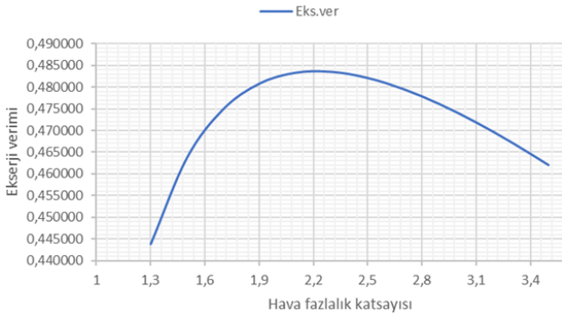
Şekil 5. Toluen iş akışkanlı gaz türbinli kombine çevrim güç tesisinde ekserji veriminin hava fazlalık katsayısı-hfk ile değişimi.
