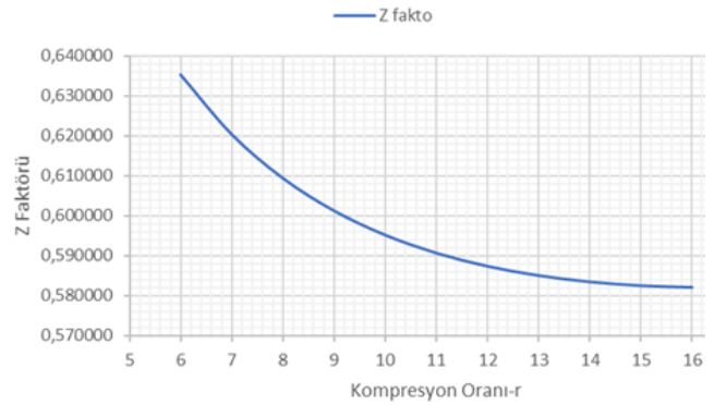
Şekil 13. Toluen akışkanlı reküperatörlü gaz türbinli kombine güç çevriminde Z faktörünün kompresyon oranı-r ile değişimi.
