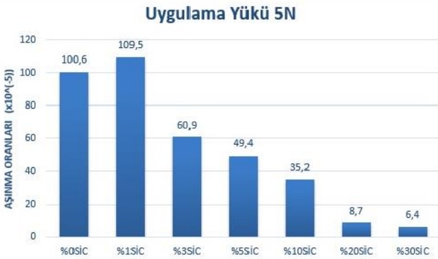
Şekil 5. 5N yükte aşınma oranları
