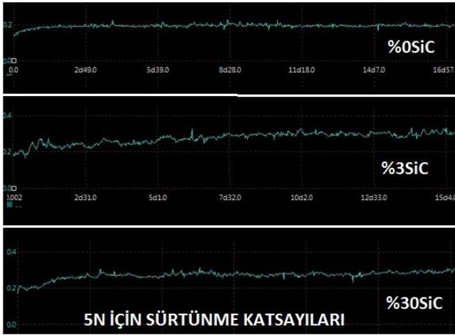
Şekil 7. 5 N için %0,3;30 SiC içeren numunelerin sürtünme katsayıları grafiği
