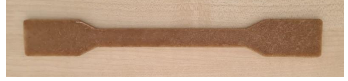
Şekil 1. Enjeksiyon kalıplama ile üretilen standart çekme test numunesi
