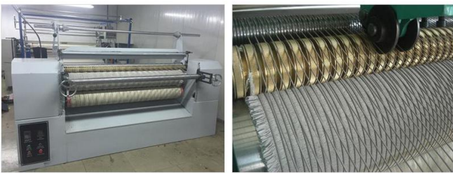
Şekil 13. Büzgü pilise makinesi [20]
