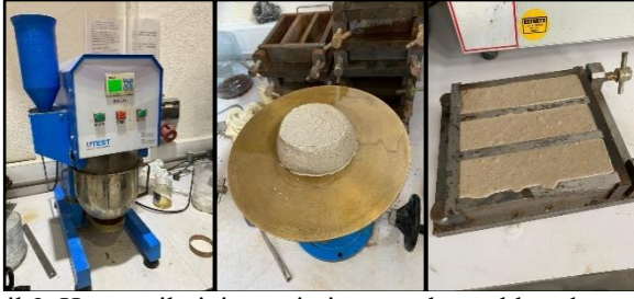
Şekil 3. Harç serilerinin üretimi ve yayılma tablası deneyi.
