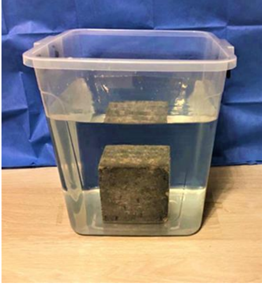
Şekil 4. Suya batırılmış beton örneği
