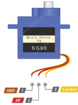
Şekil 11. 90SG Servo Motor Modülü Giriş-Çıkış Şeması [12]
