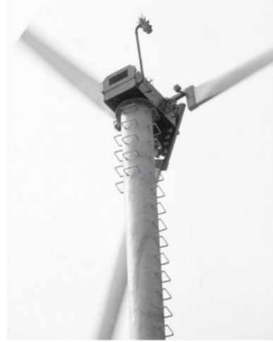
Şekil 4. Erken bir Lagerwey rüzgâr türbininde sensörlü rüzgâr yönü takipçisi [6]
