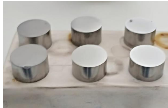
Şekil 2. Sıcak pres yöntemi ile üretilen numuneler
