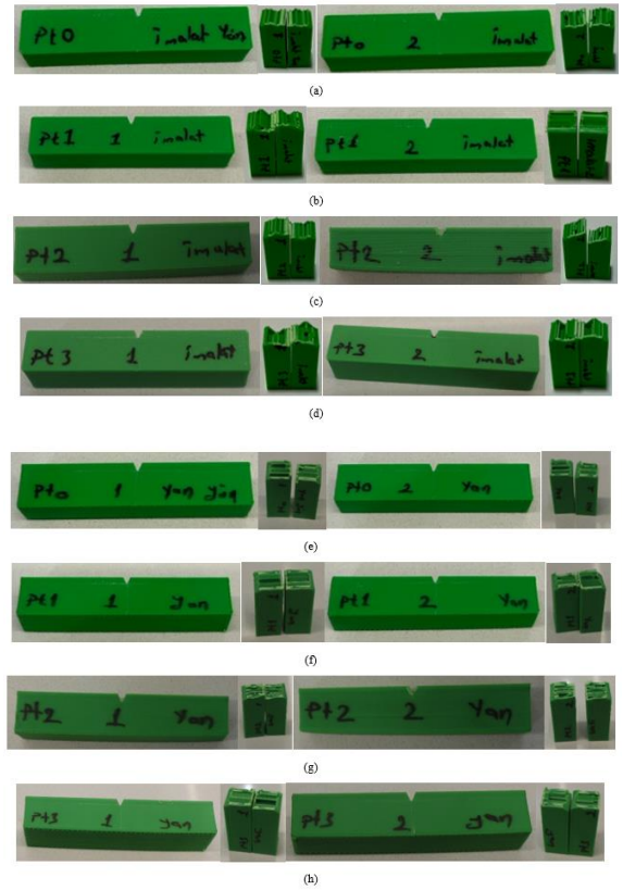
Şekil 14. Doluluk Modeli Test Parçaları İçin Yazım Yönünde ve Normalinde Numune Resimleri Darbe Çentik Numune Resimleri _ Model 1 (Dikdörtgen Desen) Yazım Yönünde Çentik Testi (a), Model 2 (Kare Desen) Yazım Yönünde Çentik Testi (b), Model 3 (Altıgen Desen) Yazım Yönünde Çentik Testi (c), Model 4 (Petek Desen) Yazım Yönünde Çentik Testi (d) _ Model 1 (Dikdörtgen Desen) Yazım Yönünün Normalinde Çentik Testi (e), Model 2 (Kare Desen) Yazım Yönünün Normalinde Çentik Testi (f), Model 3 (Altıgen Desen) Yazım Yönünün Normalinde Çentik Testi (g), Model 4 (Petek Desen) Yazım Yönünün Normalinde Çentik Testi (h)
