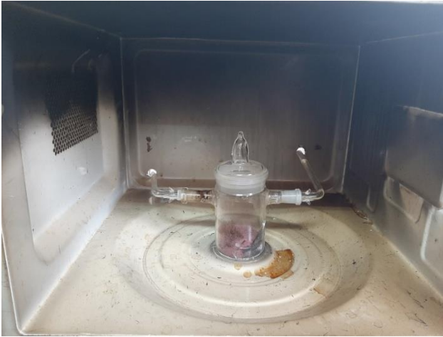
Şekil 1. Deneylerde kullanılan mikrodalga ve karbon üretim aparatı
