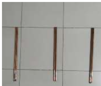
Fig. 8. Copper pipe pairs
