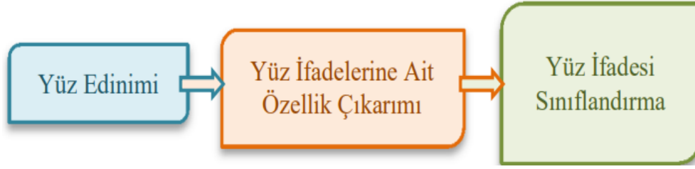
Şekil 1. Yüz ifade sistemi temel yapısı
