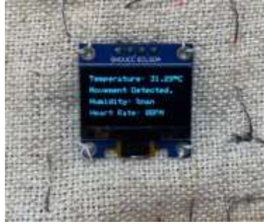
Şekil 11. SSD1306 Test Sırasındaki Görüntüsü
