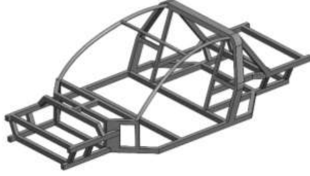
Şekil 3. İskelet Ön Tasarımı Sol Üst Görünümü
