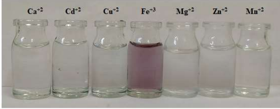
Şekil 3. HL Bileşiğinin metal iyonlarıyla renk değişimi
