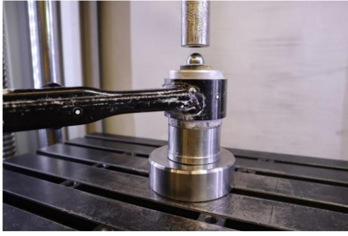
Şekil 3. Eksenel esneme testi
