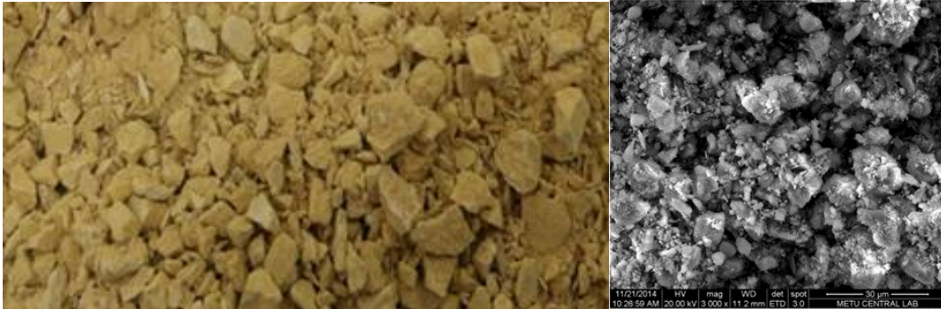
Şekil 1. Sarı Bayburt Taşı ve sarı Bayburt Taşına ait SEM Görüntüsü [8].
