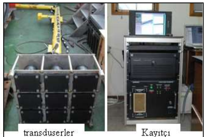
Şekil 4. CHIRP yüksek ayrımlı mühendislik sismiyi kayıtçı ve transduserleri
