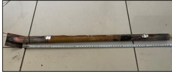
Şekil 3. İmal edilen termosifon tip ısı borusu
