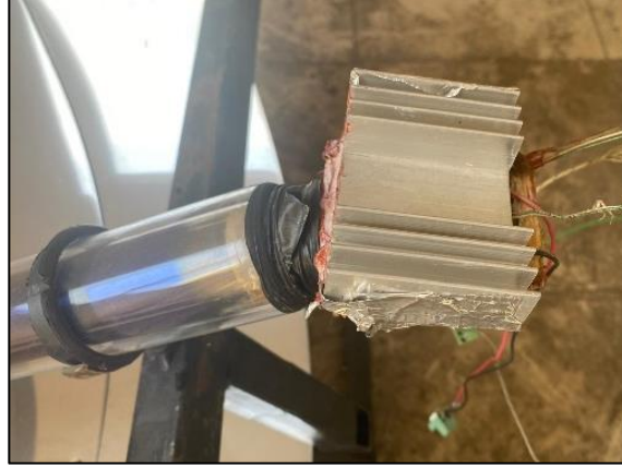
Şekil 5. Hava soğutmalı pasif soğutucu
