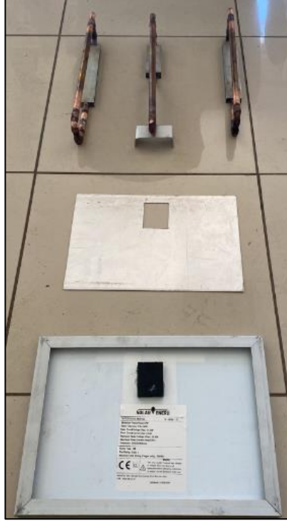
Şekil 2. Kuru tip pasif soğutucu tasarımı
