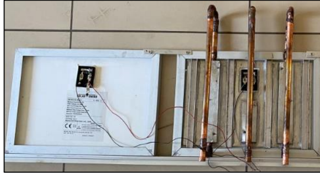
Şekil 3. Referans ile kuru soğutmalı paneller
