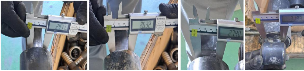
Şekil 5. Amortisör üzerinde yapılan kaynakların dikiş genişlik ölçüleri
