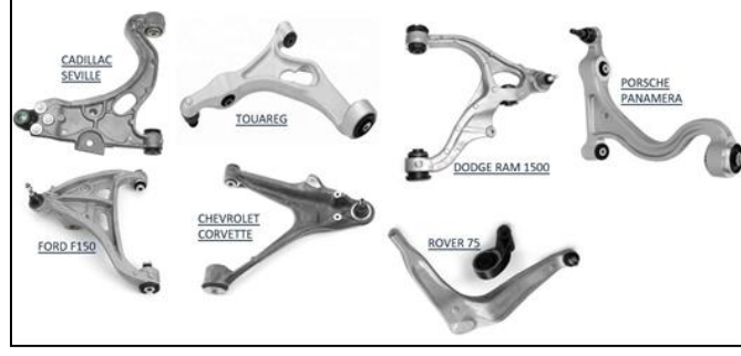
Şekil 3. Farklı geometrik şekillere sahip orijinal alüminyum salıncaklar
