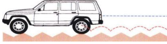
Şekil 1. Araç gövdesinin yol şartlarına göre hareketi [2].
