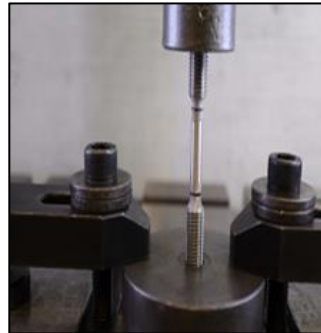
Şekil 9. Zwick roell çekme basma test cihazı ve çekme test numunesi bağlanması
