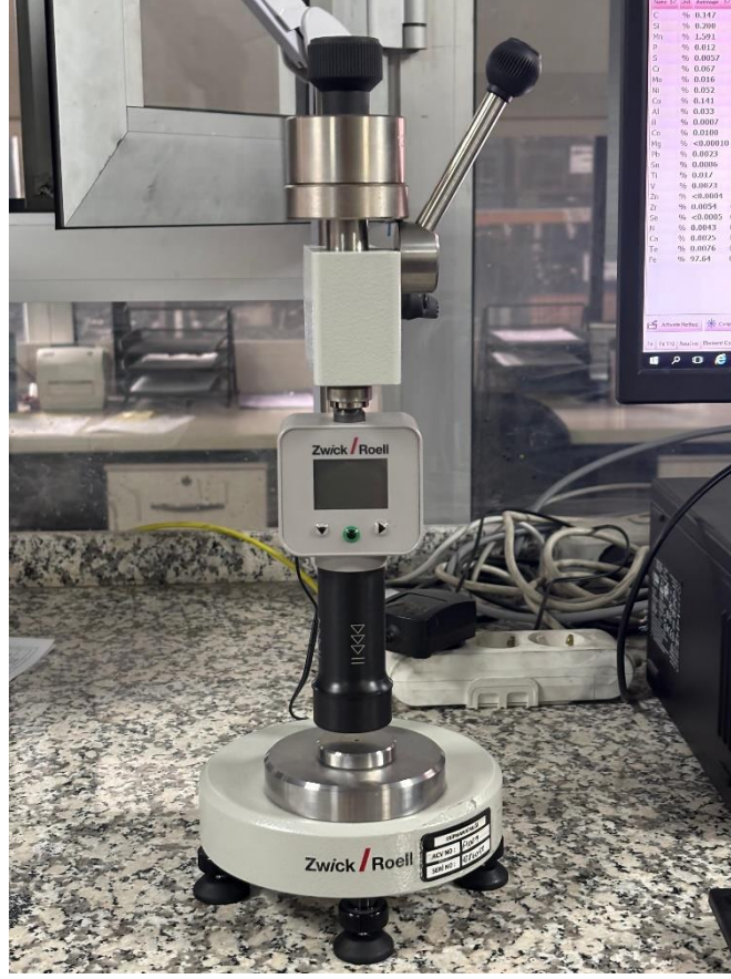
Şekil 2: Sertlik ölçümünde kullanılan Zwick-Shore sertlik ölçüm cihazı
