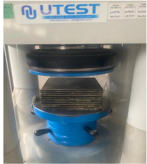
Şekil 12. Basınç Dayanım Testi
