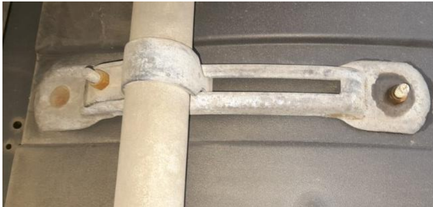
Şekil 3. Paslanan galvaniz kaplı çelik çamurluk bağlantı aparatı.
