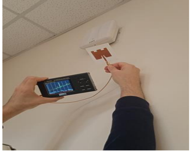
Resim 3) Üretilen antenin alıcı (receiver) olarak test edilmesi
