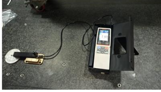
Şekil 4. Deney numunelerinin yüzey pürüzlülük cihazı ile ölçümü
