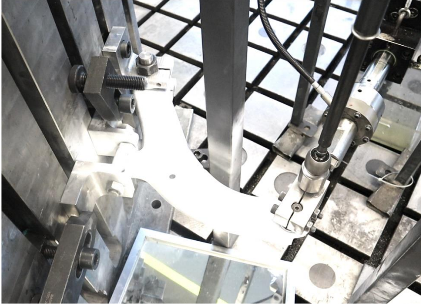
řekil 4: Gerek yol řartlarını simle eden dinamik test dzeneęi
