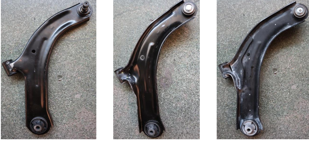
Şekil 2: Destek saclı ve destek sacsız sac salıncakların üstten ve alttan üretim sonrası fiziksel görünümü
