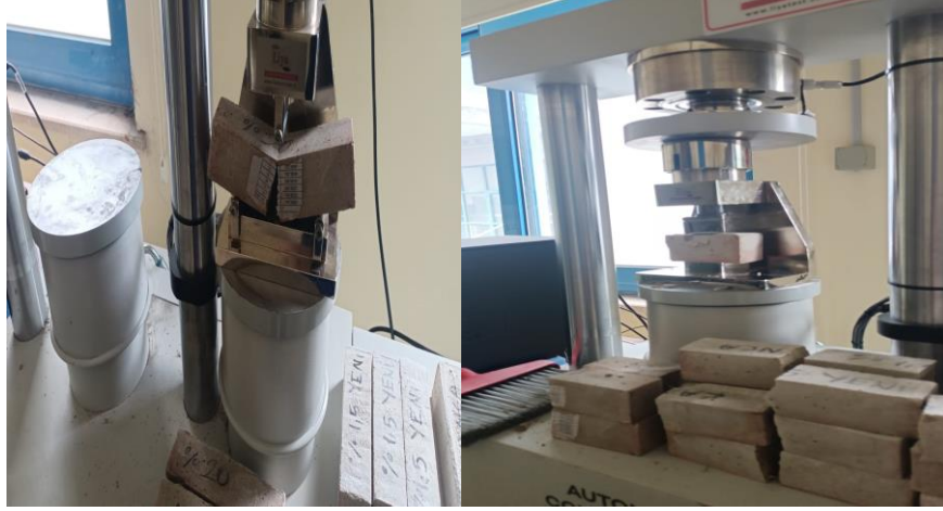
Şekil 3. Hazırlanan Seriler İle Laboratuvar Çalışmaları Eğilme Çekme Ve Basınç Dayanım Testleri
