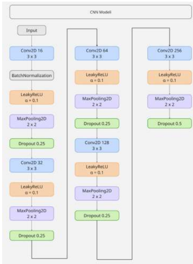
Şekil 4. Geliştirilen CNN modelinin mimari şeması
