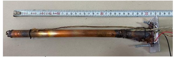
Şekil 3. İmal edilen termosifon tip ısı borusu
