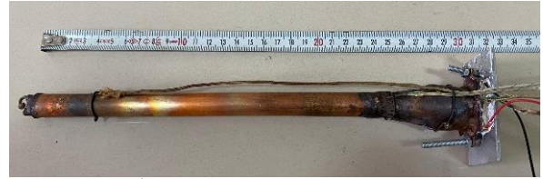
Şekil 3. İmal edilen termosifon tip ısı borusu
