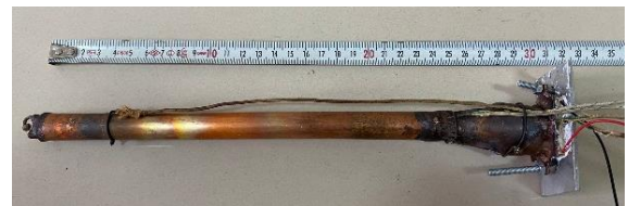
Şekil 3. İmal edilen termosifon tip ısı borusu
